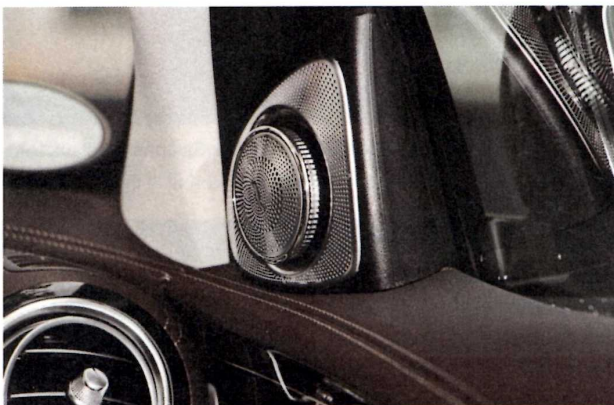
Dreh' die Anlage auf: Beim Start fahren die passend zur Farbe des Ambientelichts illuminierten Hochtöner mit einer Drehung heraus.
